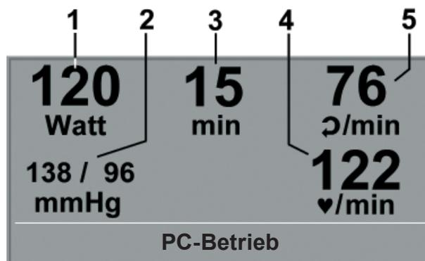
Sobald Kommandos vom steuernden EKG-Gerät, bzw. PC eintreffen, startet die Ergometrie und die entsprechenden Werte werden angezeigt.
