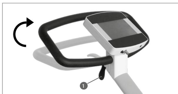
Abbildung 6-2: Verstellung Lenkerbügel
