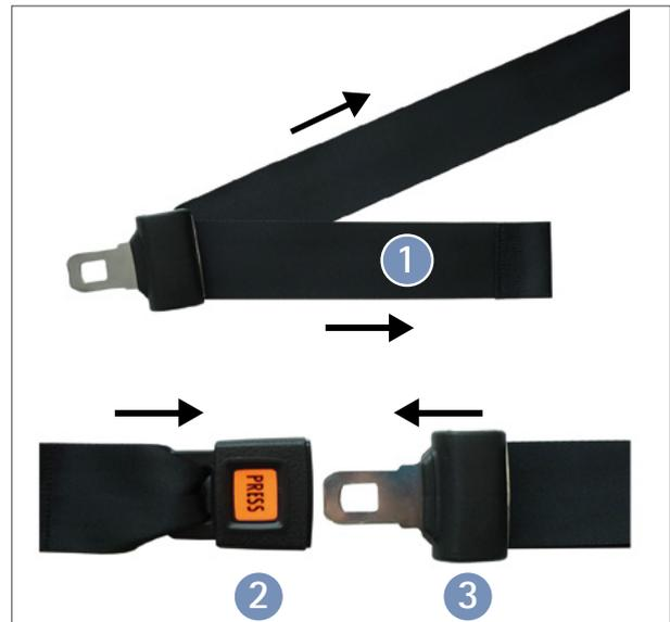
Abbildung 12 – 5: Sicherheitsgurt einstellen und verschließen
