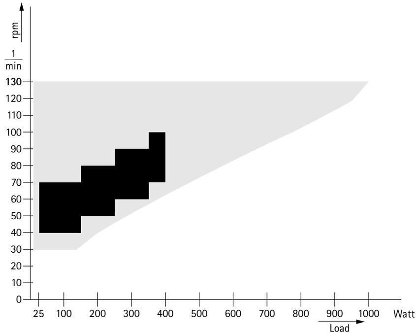
Abbildung 10-1: schwarz: drehzahlunabhängiger Bereich gemäß DIN VDE 0750-0238
