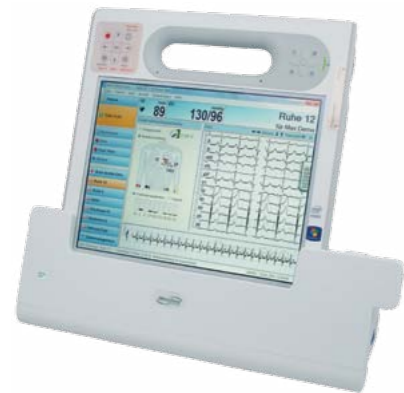
Docking-Station mit USB- und LAN-Anschlüssen, sowie Akku-Ladeeinrichtung
